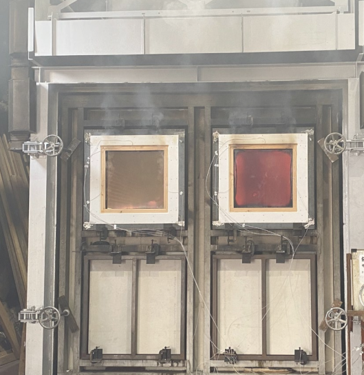
木製サッシの加熱実験
