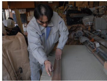
畳職による薬床菌草表取り付け作業
