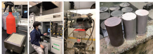
不燃認定のためのコンコロレーター試験予備実験 ©東京理科大学火災研究所 2021 0525
