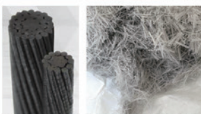
CFCC® ハイブリッド®ポリプロピレン繊維 プレストレスト緊張材に爆裂することのないカーボン ストランド:CFCC®を採用し、生コンには石灰火力 発電所由来のフライアッシュを混入した高強度コン クリートを採用。水セメント比 28 とし緻密な組成。 繊維補強を行うことで曲げ剛性の高い性質を付与。
