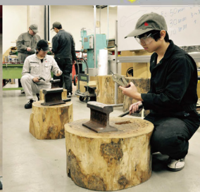
3 - 金物班による和釘の鍛金加工
