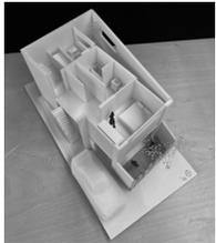
第1課題(住宅の設計)では、長方形の敷地に住宅を斜めに振って配置することで、奥まで光が差込むように設計した。第3課題(改修)では、車椅子ユーザーの妻と夫がふたりで快適に暮らせるように、光の取り入れ方に加え、スムーズな動線を確保した。さらに、吹き抜けを設けることによって、開放的な空間にするとともに、視線が通り、お互いの存在を感じられるように設計した。
